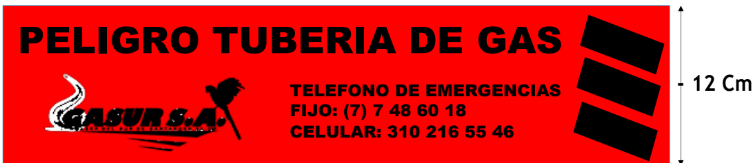
Figura No. 1. Cinta de señalización para identificación de tubería de gas.
