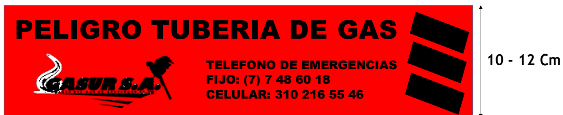
Figura No. 1. Cinta de señalización para identificación de tubería de gas.
